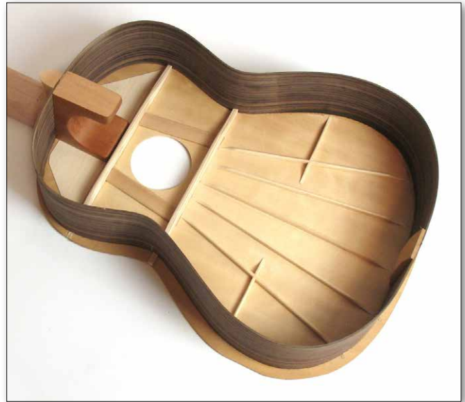
Deckenbeileistung einer Klassikgitarre
