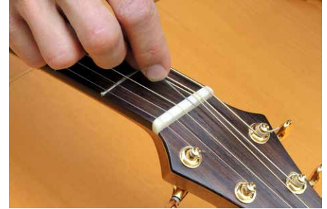
Einfeilen des Sattels
