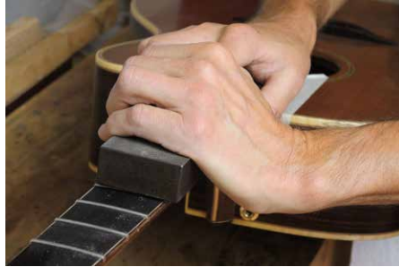
Abrichten der Bünde
