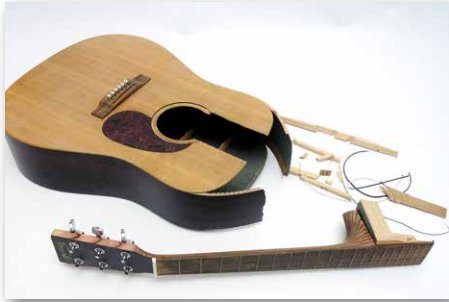
Totalschaden durch Sturz
