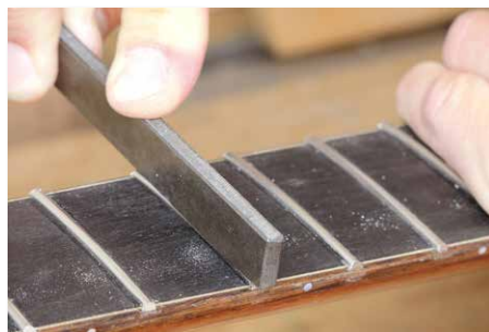
Nachprofilierung der Bundstäbchen
