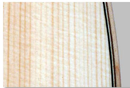
Typische Struktur der Jahresringe einer Fichtendecke
