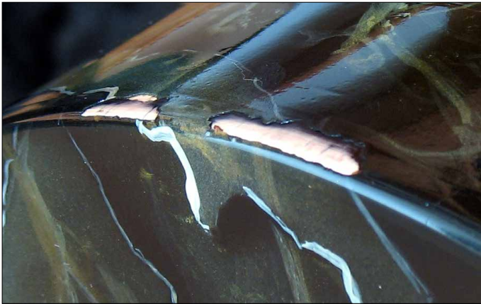
2-K-Lackschicht vom Holz gelöst
