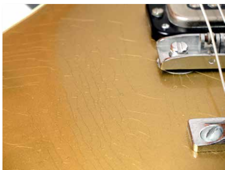
Risse im Nitrolack
