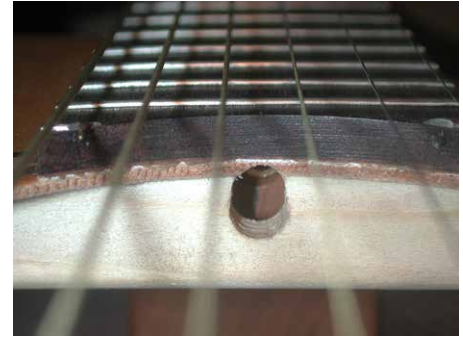
Einstellmöglichkeit des Halsstabs durch das Schalloch
