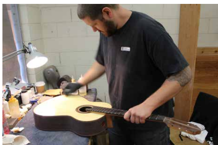
Alle in den USA gebauten Hill-Gitarren besitzen eine von Hand aufgetragene Schellack-Politur.
