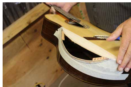
Hills Armrest kann auch bei fertigen Gitarren nachgerüstet werden.
