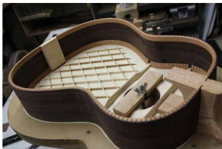
Decke mit Lattice-Bracing aus Fichte und Zeder
