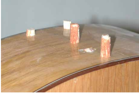
Dübel als Halsverbindung
